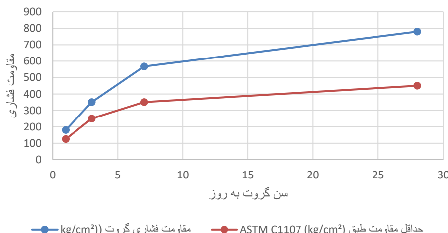
نمودار 2- روند افزایش مقاومت فشاری گروت B.C 128-G2
